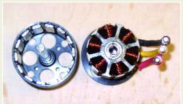
Bild links: Der Motor von Causemann: Man sieht das nach dem Auseinanderziehen verbliebene Kugellager auf der Welle. Bild rechts: Der Motor von Rolf Strecker zerlegt in zwei Teile. Die Rotorglocke links und der zugehörige Stator. Die Wicklungen sind sauber ausgeführt.
