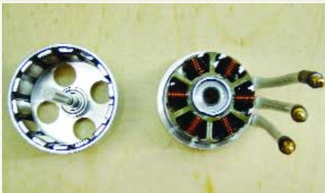
Bild links: Der Motor von Causemann: Man sieht das nach dem Auseinanderziehen verbliebene Kugellager auf der Welle. Bild rechts: Der Motor von Rolf Strecker zerlegt in zwei Teile. Die Rotorglocke links und der zugehörige Stator. Die Wicklungen sind sauber ausgeführt.
