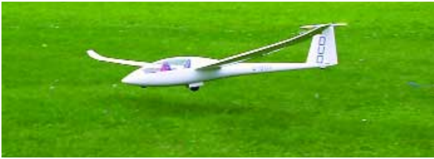
Zur Landung lässt sich der Gleitweg mit den Störklappen perfekt steuern.
